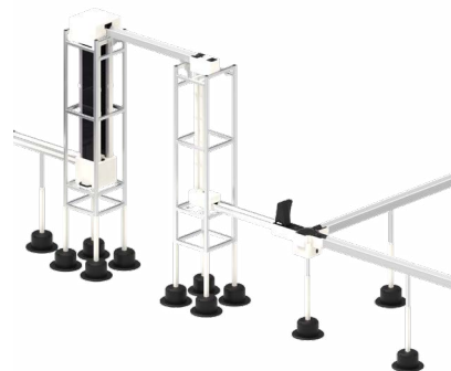
InTrac-Anbindung: kontinuierliche Probenzufuhr zum ATRAS oder Weiterleitung zum nächsten Prozessschritt
